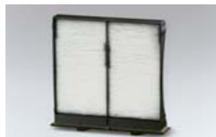
69 Filtre à pollen 72880FG000 W Réduit l'infiltration de poussière et de pollen dans l'habitacle. Pour un meilleur résultat, il est recommandé de le remplacer tous les ans ou tous les 15000 km *En remplacement du filtre d'origine
