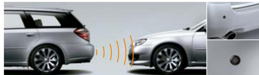
**78** Système d'aide au stationnement Ultrasonique (avant, arrière)
