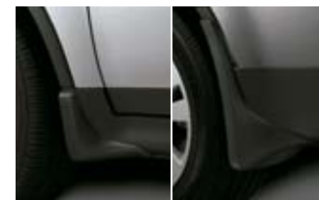
7 Jeu de bavettes (avant, arrière) J1015XA001, J101EXA000 W Protège contre la boue et la neige.
