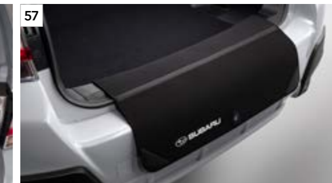
57 Protection de seuil de coffre repliable E101EAJ500 Protège le bouclier arrière lors des chargements/déchargements. Replié il peut aussi servir de revêtement antidérapant de coffre.
