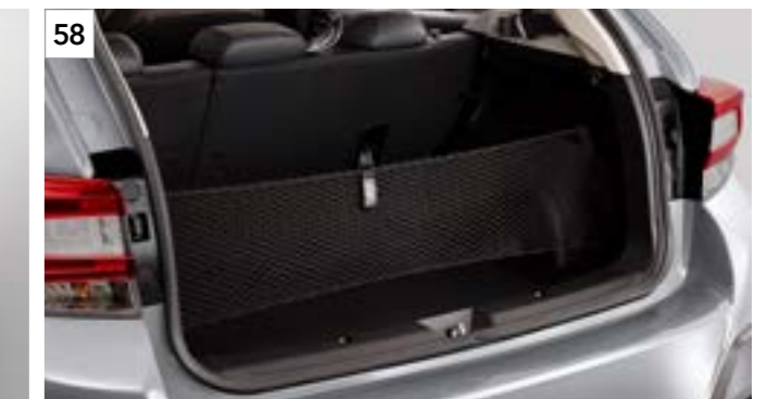
58 Filet d'entrée de coffre vertical F551SFL000 Pour éviter que les affaires s'éparpillent en roulant ou tombent lors de l'ouverture du hayon.
