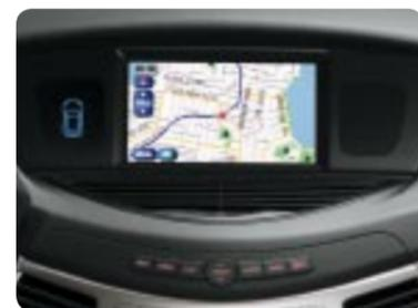
L'écran tactile monté dans le tableau de bord est l'interface de différents systèmes électroniques tels que celui de navigation DVD qui permet en quelques pressions sur l'écran de trouver sa destination. Il permet également de commander le système audio et la fonction horaire ainsi qu'un ordinateur de bord indiquant la consommation, l'autonomie et plus encore.
