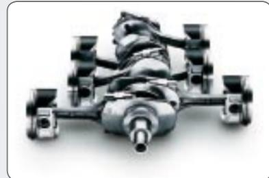
Légers et compacts, les moteurs SUBARU BOXER à cylindres à plat sont intrinsèquement plus doux et plus efficaces que les moteurs à cylindres en ligne ou en V. L'excellent équilibre dynamique provoque moins de vibrations car les pistons en annulent mutuellement les effets indésirables. En outre, grâce au concept du moteur à plat, celui-ci est implanté plus bas dans le châssis, ce qui abaisse le centre de gravité et accroît les qualités de la transmission intégrale AWD et des suspensions.
