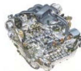
Compact et léger, le moteur 6 cylindres à plat SUBARU BOXER 2ACT développe 180 kW (245 ch). Le Système de Levée Variable des Soupapes à Commande Directe, couplé au Système de distribution à calage variable permet d'augmenter le régime moteur en douceur jusqu'à la zone rouge, pratiquement sans vibration. Simultanément, le couple généreux permet d'atteindre un niveau de performance total dans chaque rapport.
