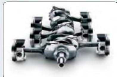
Légers et compacts, les moteurs SUBARU BOXER à cylindres à plat sont intrinsèquement plus doux et plus efficaces que les moteurs à cylindres en ligne ou en V. L'excellent équilibre dynamique provoque moins de vibrations car les pistons annulent mutuellement les effets indésirables. En outre, grâce au concept du moteur à plat, celui-ci est implanté plus bas dans le châssis, ce qui abaisse le centre de gravité et accroît les qualités de la transmission intégrale AWD et des suspensions.
