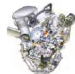
Avec ses doubles arbres à came en tête et son système de commande actif de la distribution (AVCS), ce moteur à cylindres à plat combine une montée en puissance et une réactivité exceptionnelles grâce à son système d'échappement équilibré 4 en 2 en 1 qui réduit les contre-pressions. Non seulement il en résulte une accélération linéaire et sans à-coup mais cette conception accentue également la sonorité typique des moteurs SUBARU BOXER.
