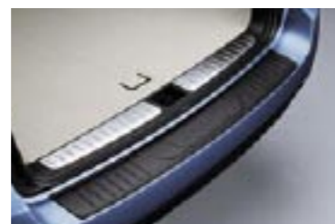
Protection de seuil de chargement (résine)
