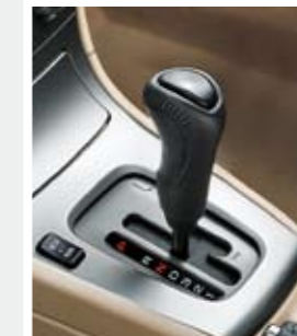
Transmission automatique à commande électronique à 4 rapports (SPORTSHIFT* BVA 4)
