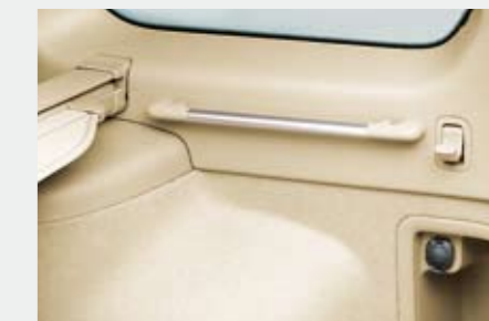
Barre de maintien, crochets d'arrimage et prise d'alimentation 12 volts
