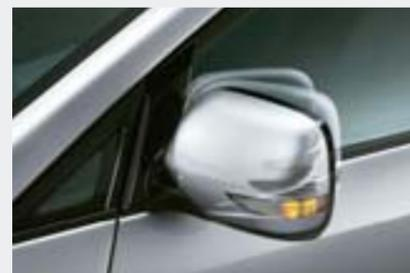
**Rétroviseurs extérieurs électriques avec clignotant à LED intégré**
