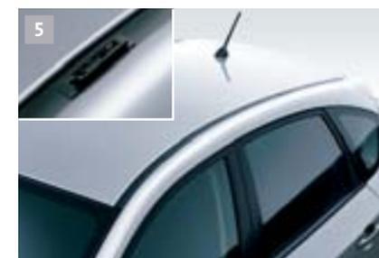
Système de fixation de barres de toit
