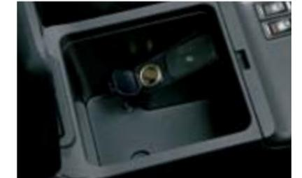
Prise d'alimentation 12 volts (intégrée au casier de console centrale)
