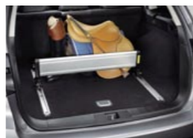
Arrêt de charge sur rails de coffre
