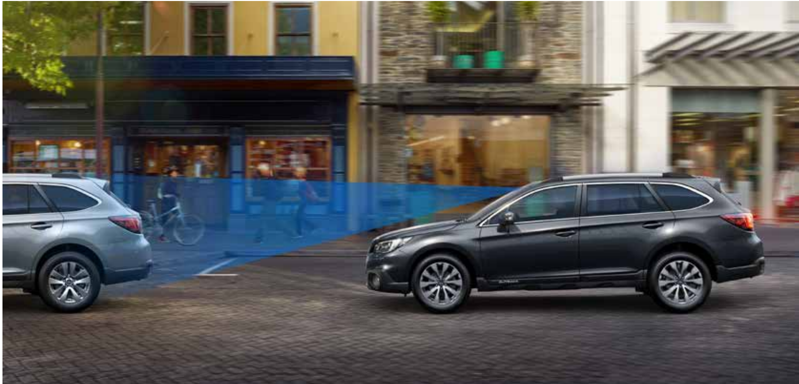
Champ de vision du système EyeSight (à noter qu’il ne s’agit pas d’une mesure réelle)
