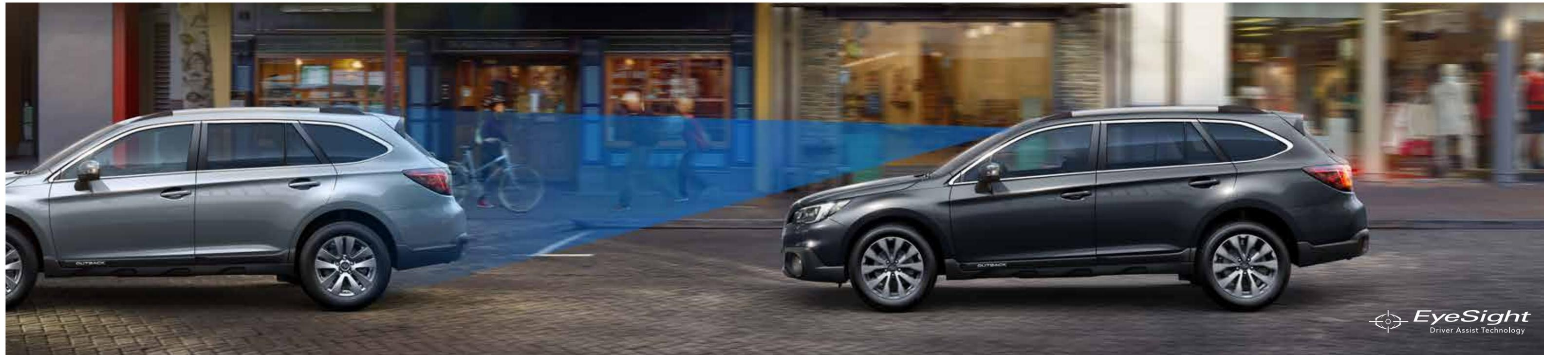
Champ de vision du système EyeSight (à noter qu'il ne s'agit pas d'une mesure réelle)
