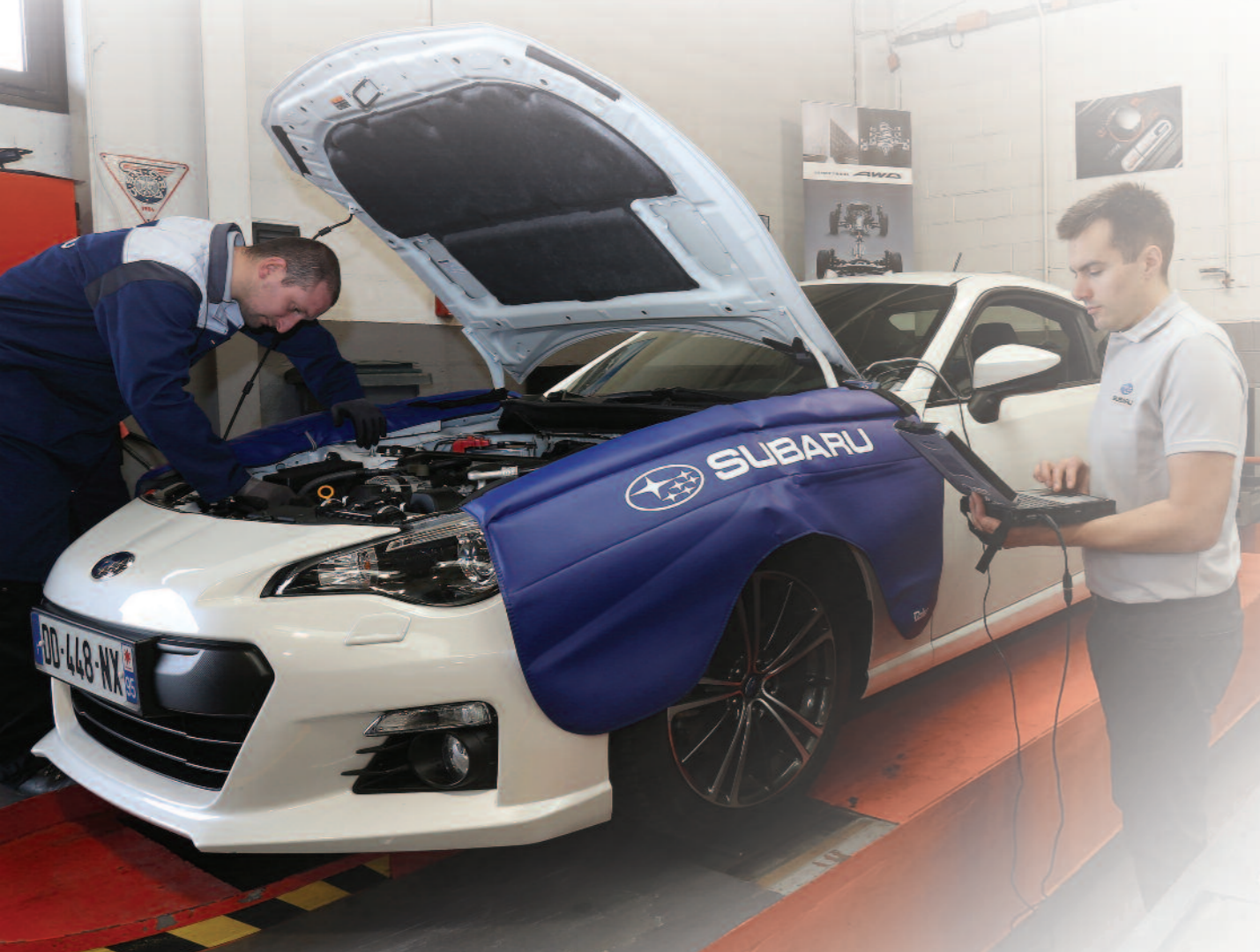
Pour les simples opérations de vidange, les techniciens appliquent une procédure bien précise et emploient un lubrifiant Motul spécialement développé pour Subaru France.
